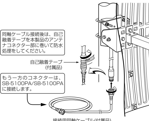
②もう一方の接続用同軸ケーブルの端を、SB-5100PA/SB-5000PAの[Wireless 1]側コネクターに接続します。
